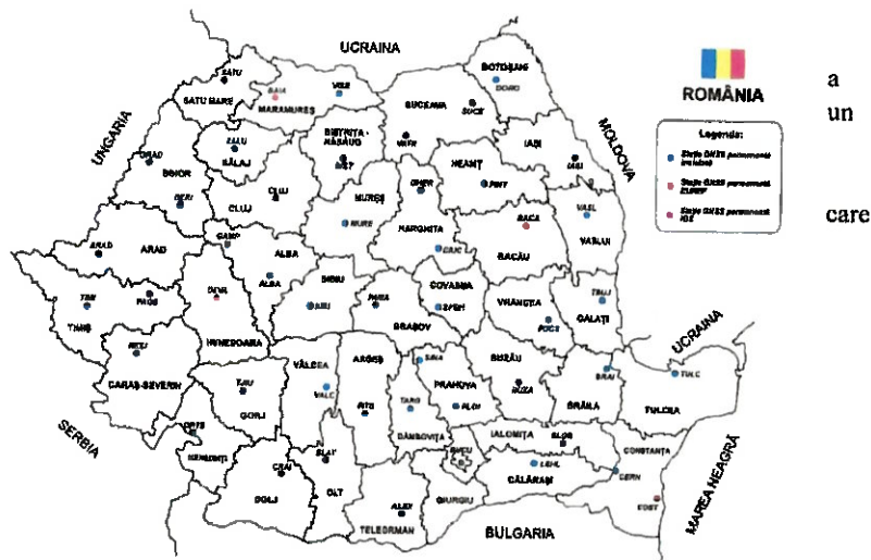
Schema Rețelei Naționale de Stații GNSS Permanente (2008 - 48 stații) Perspectivă 2009 - 73 stații GNSS permanente; Distanța medie între stații - cca. 70 km
